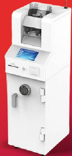
La terminal de depósito de efectivo **DM-2200** está diseñada para depósitos continuos y clasificación de hasta 720 billetes por minuto. Con una capacidad de 10.000 billetes, es perfecta. Equipada con un sistema de custodia que cumple con el estándar UL291 y fabricada con acero de media pulgada de grosor, garantiza la máxima seguridad. También admite depósitos en sobres, brindando versatilidad y confianza en cada transacción.
